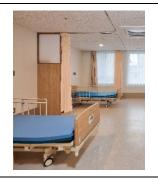
合併症病棟の4床室。お互いの視線が気にならないように、ベッドの間には奥行70cmの袖壁を設置した。ベッド毎に酸素・吸引のアウトレットと、非常電源コンセントを準備。平均年齢が75歳前後と高い上に経管栄養・医療ガス・生体モニターの使用者も多く、殆どが1日をベッドで過ごされることから、ベッド周りの私物は多くはないこと、医療機器の設置スペースの確保・ベッドの取り回しを考慮し、収納は移動が容易な床頭台を使用した。ベッド毎に照明の調光スイッチがあり、夜間のケアにも対応する。
