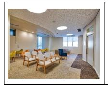
精神科外来の待合では 2 つの診察室の入口を同一壁面に真横に並べるのではなく、各々に角度を付けた壁に設けた。待合と真正面に向かないようにすることと、出入のタイミングが重なった場合の視線の交叉を避けるため。更に、横並びに座る人同士が微妙に違う方向を向くような放射線状の待合椅子を採用。もう一つの認知症外来は、精神科とは受付を経て、左右に分かれた場所にある。こじんまりした専用のスペースは、アールの壁で包まれ、視線をはばかることなく待って頂ける工夫をしている。床をカーペットにしたことで音を吸収するだけでなく、天井照明の反射がない視覚的にも静かな空間を創り出している。
