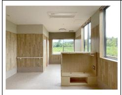
秋棟 西ユニット個室・視力障害、 発作、身体に不自由があり、身体的 介助も必要な方が多く入所される。 体を壁にぶつける行為に対して、ク ッション性のある床材を壁に採用。 トイレに行き易くするため、ベッド エリアの近くに配置。
