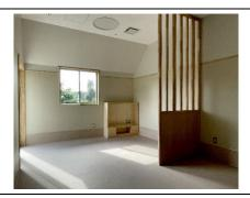
夏棟・西ユニットの個室。14 畳を標準とするが、12 畳タイプが3 室ある。余暇で過ごす場所と、寝る場所は木製スクリーンで分けた。めくれ易い壁紙は使わず、塗装仕上げ。設備に手の届かない高い天井が特徴。
