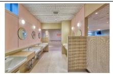
トイレに付属する手洗いは洗面所 としても使用されるが、「トイレ で顔を洗う、歯を磨く」という状態は好ましくない。 トイレと洗面のエリアを床・壁の 色、袖壁等で明確にしている。
